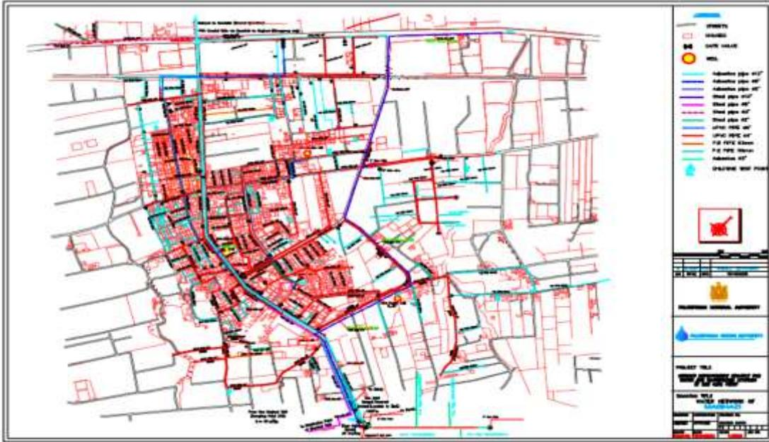
شكل (1.2): مخطط شبكة المياه لمخيم المغازي<sup>(3)</sup>
